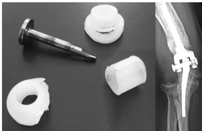
Рис. 3. Разрушение шарнирного узла эндопротеза Zimmer Coonrad – Morrey
