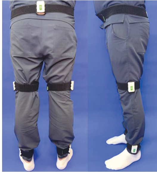
Рис. 1. Пример установки инерционных сенсоров при обследовании пациента
