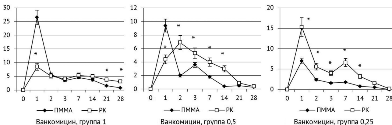
Рис. 2. Динамика высвобождения ванкомицина (% от общей массы введенного антибиотика) из тестируемых материалов (Ме, интерквартильный размах). * — достоверность различий между сериями при p < 0,05 . По оси абсцисс — сутки инкубации
