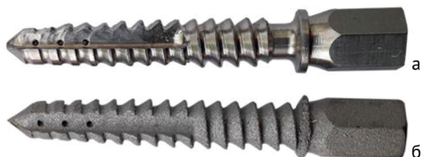
Рис. 1. Имплантаты из ультрамелкозернистого сплава Ti Grade 4 после механической обработки (а) и сплава Ti6Al4V после селективного лазерного сплавления (б); установка имплантатов в культю большеберцовой кости кролика (в)
