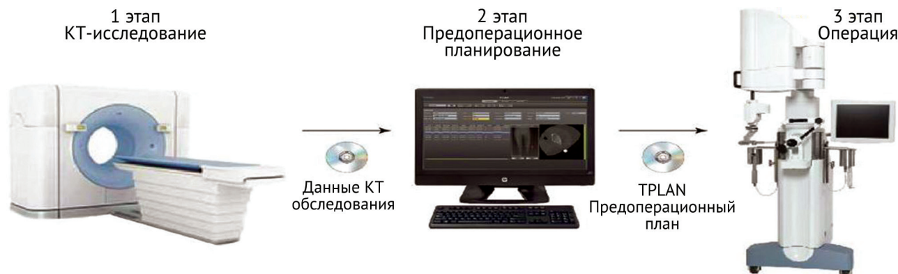
Рис. 1. Технологическая схема работы роботической ортопедической системы TSolution One® (THINK Surgical Inc., США)
