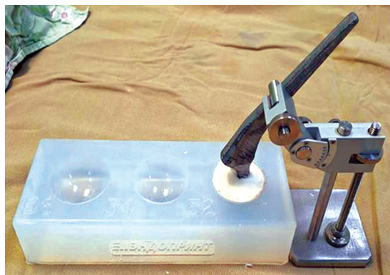
Рис. 2. Устройство для удержания арматуры спейсера
