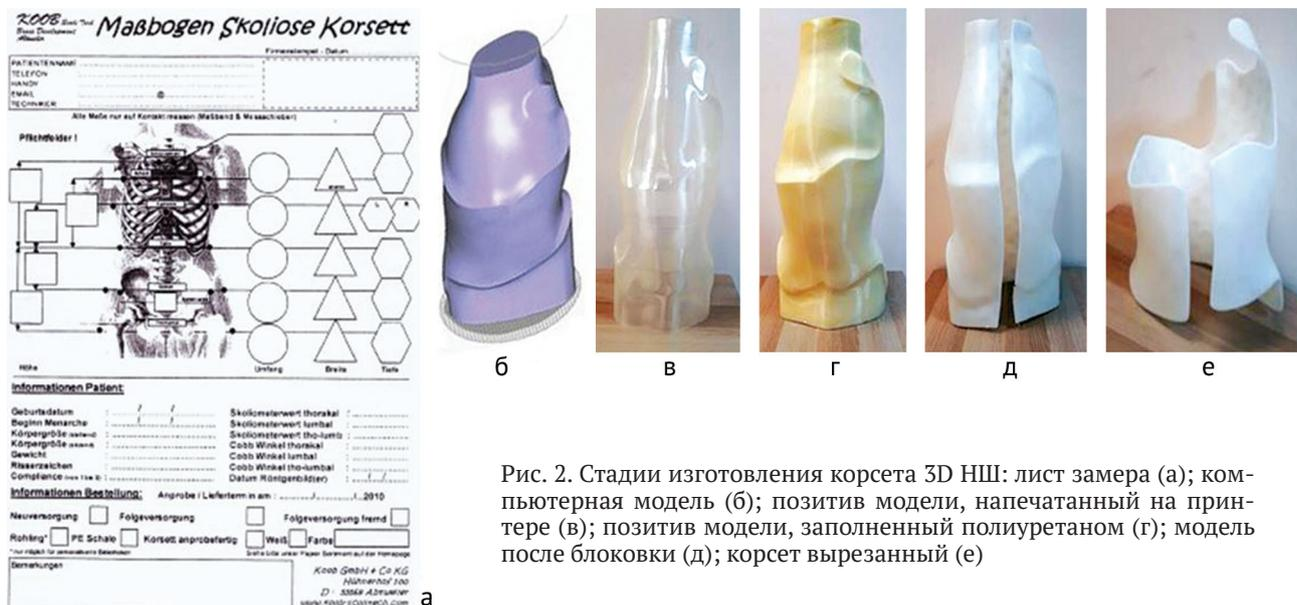
Рис. 2. Стадии изготовления корсета 3D НШ: лист замера (а); компьютерная модель (б); позитив модели, напечатанный на принтере (в); позитив модели, заполненный полиуретаном (г); модель после блокровки (д); корсет вырезанный (е)
