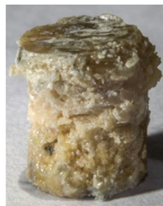
Рис. 3. Образец после механических испытаний на одноосное сжатие
