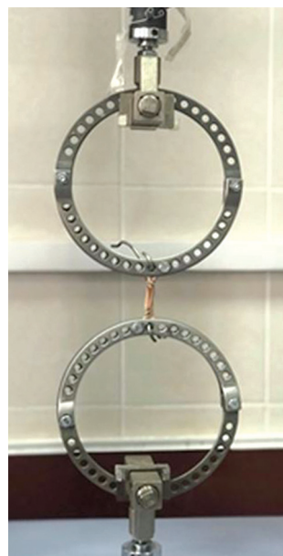
Рис. 2. Вариант фиксации модели трансплантата с помощью металлических крючков в импровизированных зажимах
