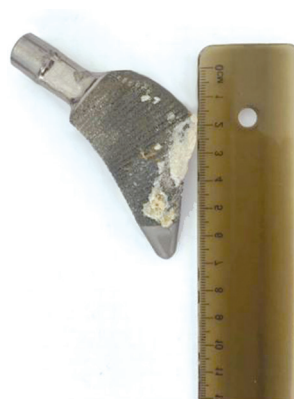
Рис. 2. Удаленный бедренный компонент эндопротеза с бесцементной фиксации
