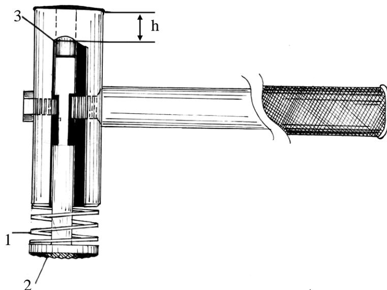
Рис. 1. Экспериментально-учебный молоток для определения усилий остеотомии
