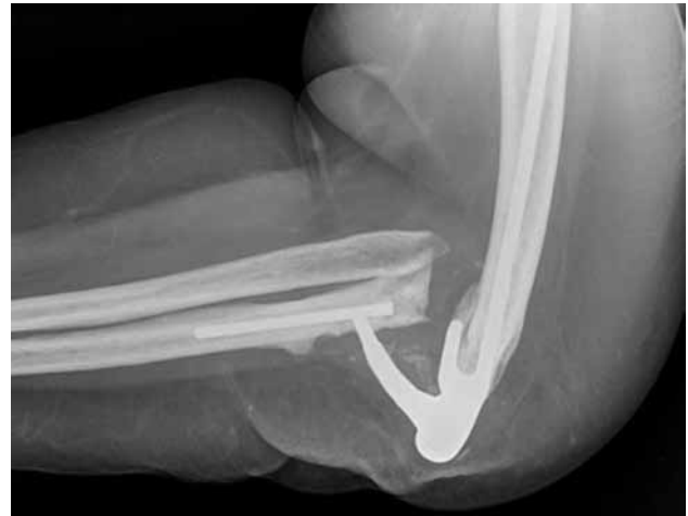
Рис. 5. Рентгенограмма локтевого сустава в боковой проекции. Разрушение локтевого компонента эндопротеза Coonrad-Morrey. Усталостный перелом возник вследствие наличия в проксимальном отделе локтевой кости дефекта, который не был замещен трансплантатом при выполнении артропластики
