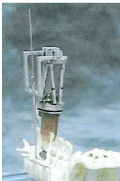
Рис. 7. Робот-система «Spine Assist™» (Mazor Surgical™) направляет инструментарий для установки транспедикулярных винтов. Она компактна и фиксируется непосредственно на остистом отростке позвонка
