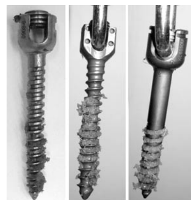
Рис. 6. Транспедикулярные винты непосредственно после вытягивания: а — винт первой контрольной группы; б — винт второй контрольной группы; в — модифицированный винт
