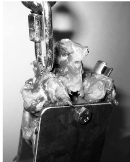
Рис. 3. Устройство для фиксации позвонков в траверсы испытательного стенда: а — устройство в сборе; б — устройство с экспериментальным образцом в траверсе испытательной машины
