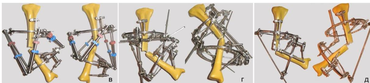
Рис. 4. Угловые перемещения костных фрагментов во фронтальной плоскости: а – аппаратом TSF (средние длины страт); б – аппаратом TSF (весь диапазон длин страт); в – аппаратом ИНА; г – аппаратом SUV-Frame; д – аппаратом Илизарова
