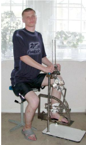
Рис. 4. Исследование силы мышц сгибателей и разгибателей стопы больного К. на стенде, разработанном в РНЦ «ВТО»
