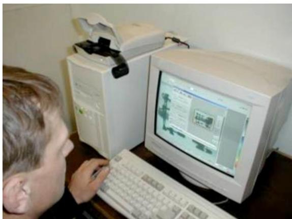
Рис. 7. Ввод изображения в компьютер с пленочного сканера (показан в положении укладки пленки, в рабочем положении крышка опущена)
