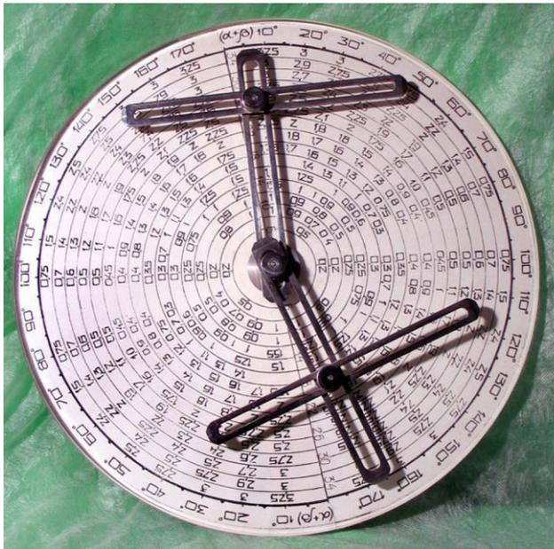
Рис. 2. Фотография учебного макета устройства для расчета удлинения сегмента конечности с одновременным устранением его деформации
