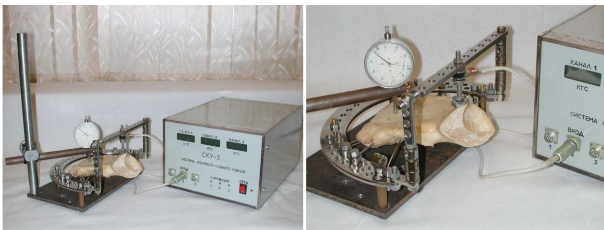
Рис. 2. Стенд для изучения жесткости фиксации тазовой опоры и аппаратура для измерения осевого усилия
